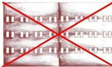
Das Verlegen von Ballspielflächen sollte so erfolgen, dass die Spielrichtung entgegen der Steckverbindung verläuft.
